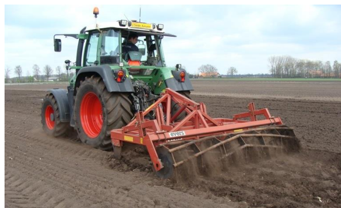
Figuur 4. De hoofdgrondbewerking bij NKG is uitgevoerd met een vaste tand cultivator.
